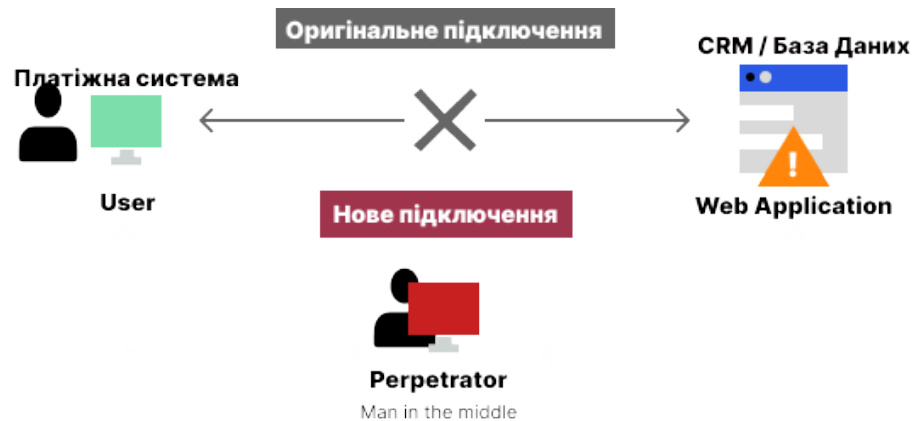
Рис. 4.2 Схема MITM-атаки в платіжній системі
